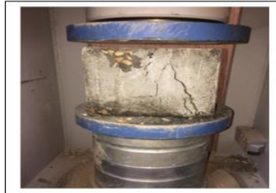
شكل (2) يوضح اختبار مقاومة الضغط للمكعبات
